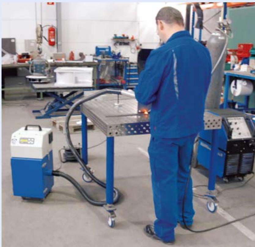
Anwendungsbeispiel: Dauerläuferversion mit Saugschlauch und Absaugdüse
