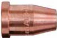
Bei diesen Düsentypen ist die Schneiddüse für alle Brenngase gleich. Der Einsatz verschiedener Brenngase wird über die entsprechende Heizkappe erreicht. Nähere Einzelheiten im Kapitel Brennschneiddüsen – Injektortyp, Seite 47.
