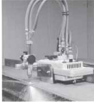
ProFIT für automatische Geradeschnitte durch Winkelprofilführung
