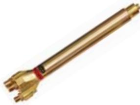
Passend zu den Schneiddüsenpaketen für Acetylen (AC + A-SD + A-HD 10) und Propan (PUZ 89 + P-SD + PY-HD 10), Katalogseite 42 und 44, Schaftlänge 220 mm/320. In die Brennertypen BIR 220/32 A+ und BIR 220/32 PMY+ ist ein patentiertes Sauerstoffkühlstromventil eingebaut. Dies bewirkt eine erhöhte Düsenstandzeit durch effiziente Kühlung der Schneiddüse während des Vorwärmens auf Zündtemperatur.
