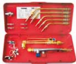
Löt-, Anwärm- und Schneidgarnitur in Sonderzusammenstellung bestehend aus: 1× Griffstück, 4× S-Anwämbrenner, 1× Federhebelschneideinsatz, 4× Schneiddüsen PUZ 89 bis 100 mm, 1× Heizröhre 3-100 mm, 1× Führungswagen, Stahlblechkasten.
