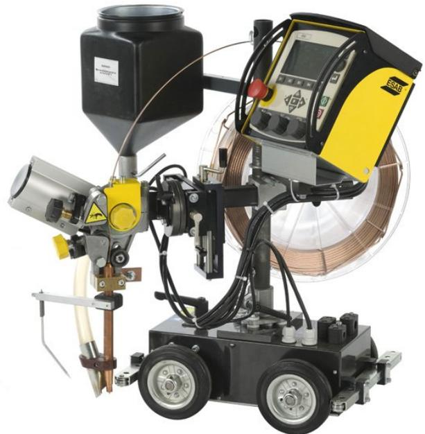
Vielseitige mechanische Einstellmöglichkeiten über Linear- und Winkelsupporte ermöglichen die optimale Positionierung des UP-Schweißkopfes. Der Traktor besitzt einen kräftigen Fahrwagen mit geregeltm Vierradantrieb, so dass auch in leicht geneigten Positionen sicher geschweißt werden kann. Der großzügig ausgelegte Drahtantrieb sichert einen konstanten Drahtvorschub und eine gleichmäßig gute Schweißqualität.
